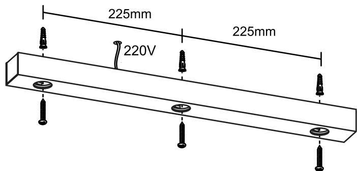
**ВАЖНО:** Установка светильника должна производиться при обесточенной электросети.
